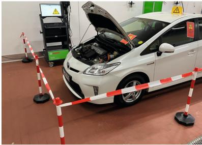
Fahrzeug in Parkposition bringen, Schlüssel vom Fahrzeug entfernen und das Fahrzeug vor unbefugtem Zugriff sichern.
