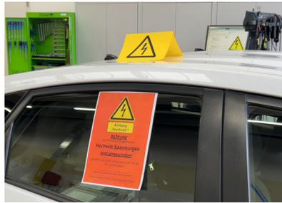
Schild am Fahrzeug anbringen, welches signalisiert, dass das Fahrzeug noch nicht freigeschaltet ist, zusätzlich das Dreieckshütchen auf dem Dach positionieren.
