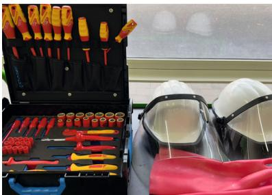
Das Werkzeug sowie die Schutzausrüstung vorbereiten (Schutzbrille, isoliertes Werkzeug, Kabelschutz und isolierte Handschuhe).
