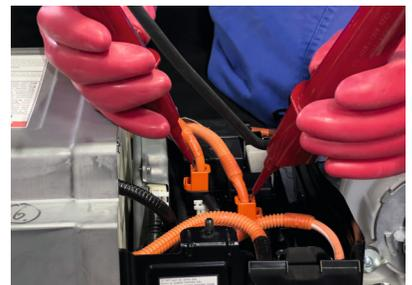
Je nach Fahrzeughersteller ist jetzt die Spannungsfreiheit am Fahrzeug zu prüfen, diesen Vorgang entnehmen Sie bitte den entsprechenden Unterlagen des Fahrzeugherstellers.
