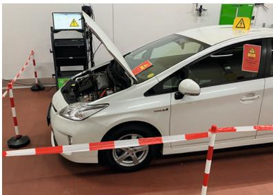
Schild am Fahrzeug, welches signalisiert, dass das Fahrzeug nun freigeschaltet ist, anbringen.
